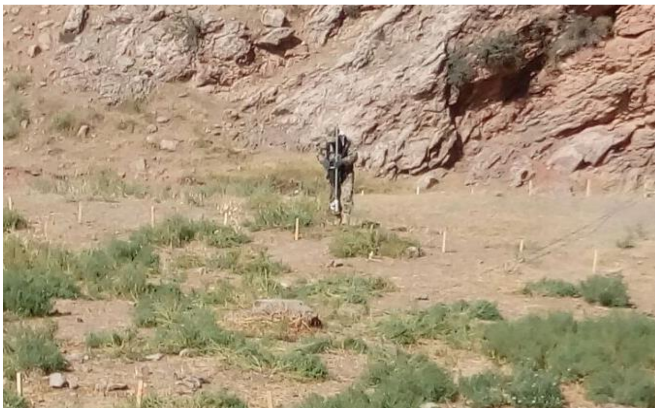
Рис. 1. Процесс проведения магниторазведочной съемки
