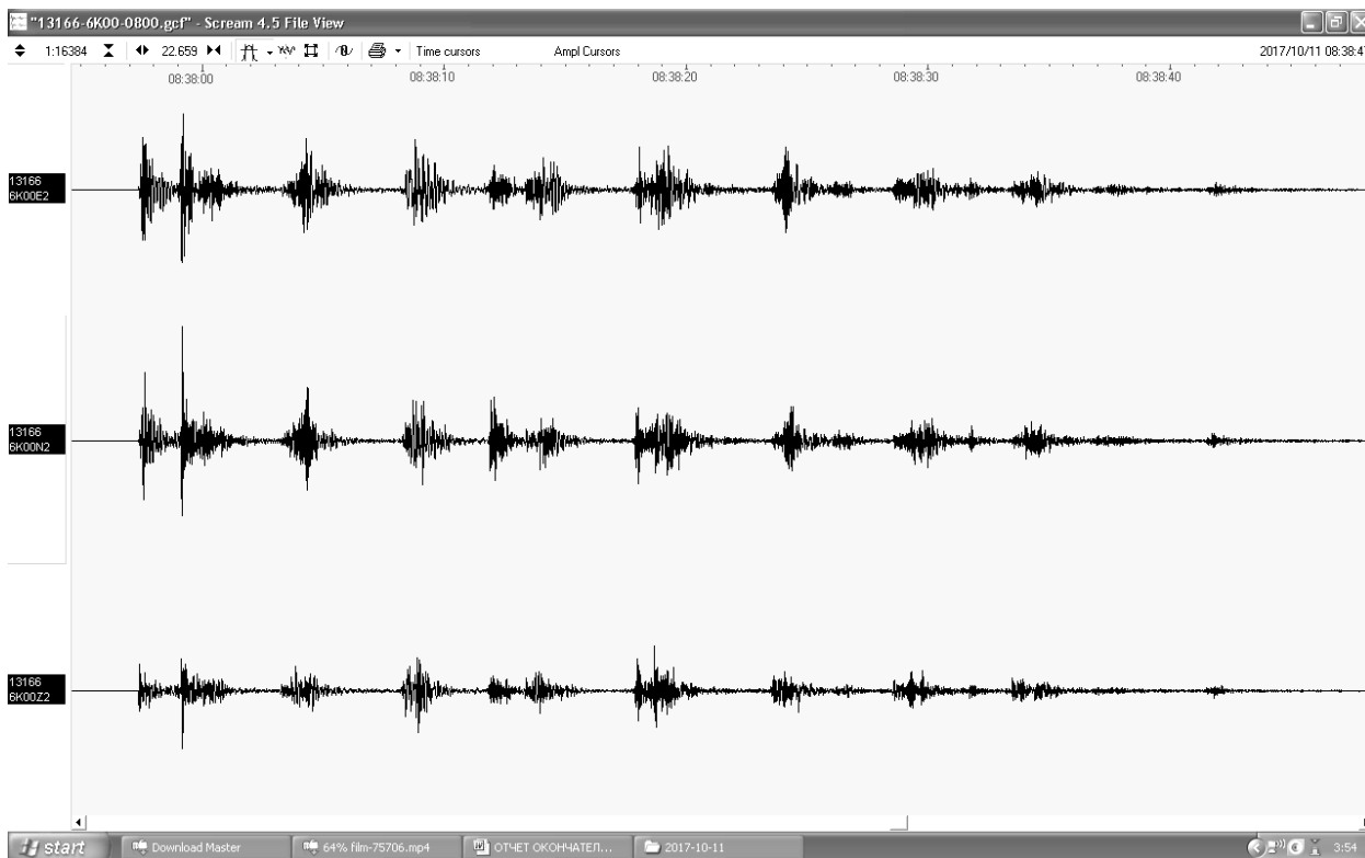
Рис.17. Запись взрыва на «деформация № 50».
