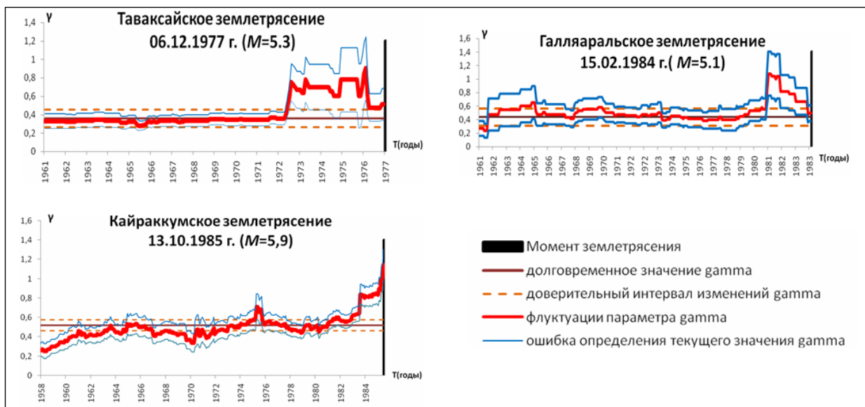
Рисунок 10 – Примеры проявления предвестника аномалии сейсмической дробности (параметр \gamma ) перед некоторыми землетрясениями на территории Узбекистана.
