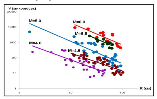
1-расм. Фарғона ботиқлигида магнитудаси М=4,0-6,0 бўлган зилзилалар учун грунтнинг тебраниш тезлиги амлитудалари сўнишининг экспериментал маълумотлари
