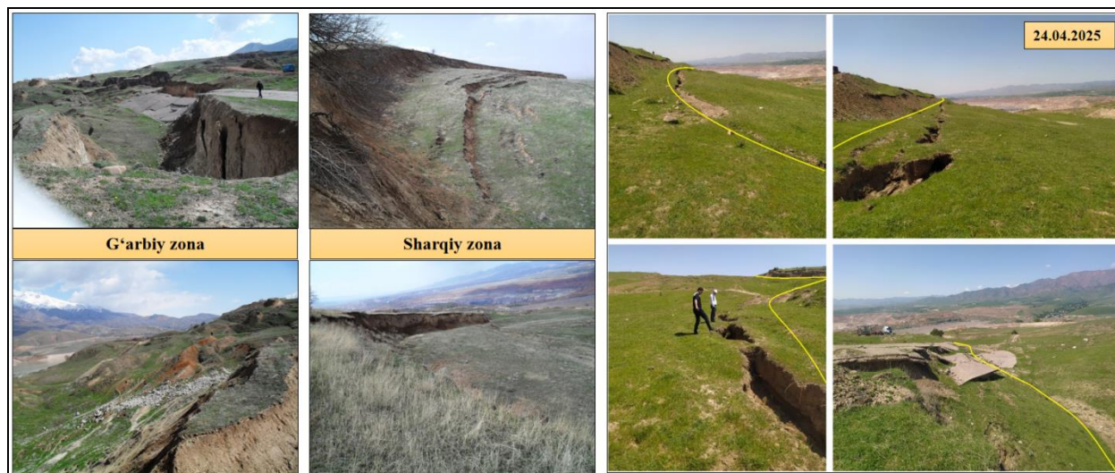
1-rasm. Yuqori-Turk ko'chkisining morfostrukturaviy tuzilishi va yoriqlanish zonalari.
