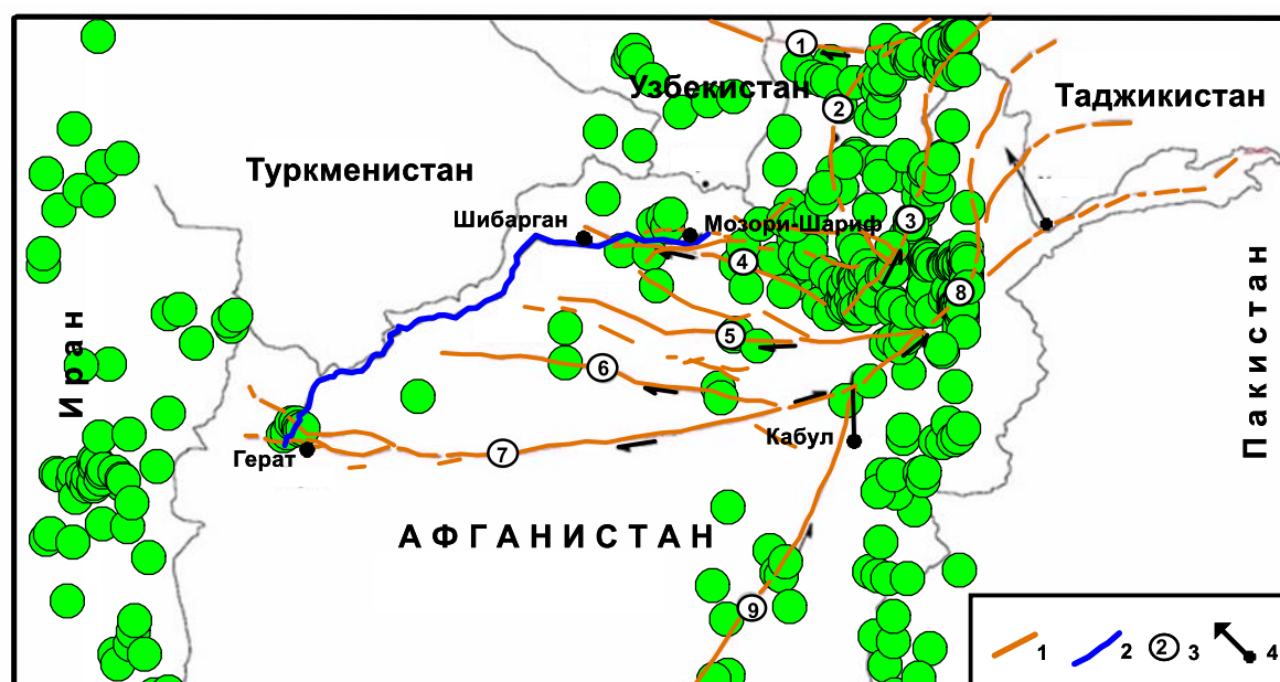
Рис. 4. Карта активных разломов и эпицентры землетрясений с M \leq 5,0 северной части Афганистана. Эпицентры землетрясений, по [https://earthquake.usgs.gov/earthquakes/search]. 1 – разломы земной коры; 2 – линия железной дороги; 3 – номер разлома; 4 – направления движения пунктов, по данным GPS.
