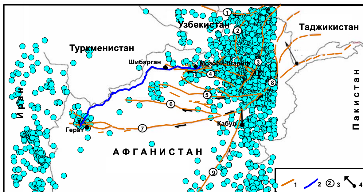
Рис. 5. Карта активных разломов и эпицентры землетрясений с M \leq 4,0 северной части Афганистана. Эпицентры землетрясений, по [https://earthquake.usgs.gov/earthquakes/search]. 1 – разломы земной коры; 2 – линия железной дороги; 3 – номер разлома; 4 – направления движения пунктов, по данным GPS.
