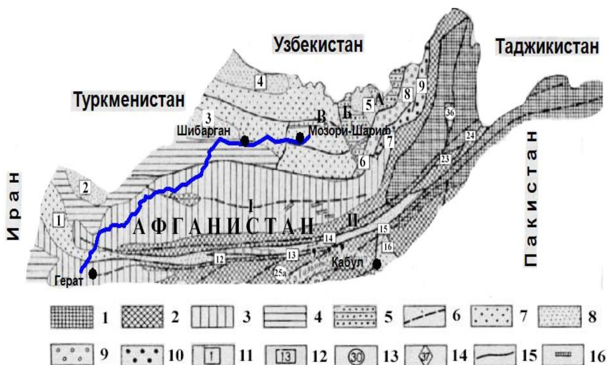
Рис. 1. Схема новейшей тектоники Афганистана, по [5]. Сводово-глыбовые поднятия: 1 – районы максимального (свыше 5200 м) поднятия; 2 – районы весьма интенсивного (более 3500 м) поднятия; 3 – районы интенсивного (более 2500 м) поднятия; 4 – районы умеренного и слабого (менее 2500 м) поднятия (первая ступень); 5 – поднятые блоки внутри области опускания (А – Обигармский, Б – Кафир-Памиронианский, В – Альбурзский); 6 – оси сводово-глыбовых поднятий (I – Банди-Туркестанского, II – Памиро-Паропамизского). Области опускания: 7 – слабые (менее 100 м), 8 – средние (до 500 м), 9 – интенсивные (свыше 2000 м), 10 – весьма интенсивные (свыше 5000 м); 11 – предгорные впадины и их номера (1 – Нижне-Герирудская, 2 – Кушкская, 3 – Даулятабадская, 4 – Келифская, 5 – Вахшская, 6 – Пулихумрийская, 7 – Ишккешская, 8 – Кулябская, 9 – Кокчинский грабен, 10 – Сейстанская неотектоническая впадина, 11 – Хамунская впадина); 12 – межгорные впадины и их номера (12 – Чакхаранская, 13 – Яковланская, 14 – Бамианская, 15 – Чарикарская, 16 – Баграмская, 23 – Анджуманская, 24 – Зобакская). 13 – внутригорные впадины (цифры на схеме): 25а – Пенджабская, 15 – разломы, активизированные в неоген-четвертичное время; 16 – современные сейсмогенные разломы и палеосейсмодислокации.
